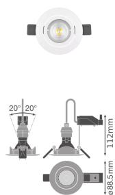
**Technische Daten Ledvance LED-Spot Kit schwenkbar GU10 PAR16 8.3W 520lm 36D - 940 | Höchste Farbwiedergabe - Dimmbar - Ersatz für 65W**
