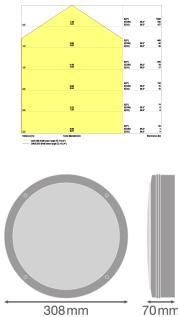
Technische Daten Ledvance Surface Bulkhead 300 15W 840 1400lm Schwarz IP65 | Notbeleuchtung 3H inkl. Sensor
