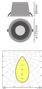
**Technische Daten Ledvance LED Deckenstrahler Biolux HCL Zigbee Gen 2 Aluminium Weiß 20W 2100lm 60D - 927-965 Abstimmbares Weiß | 175mm - Ausschnitt 160mm - IP20 - ZigBee**
