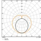
Technische Daten Ledvance LED Röhre T8 EM Superior Conventional (EM), Mains (AC) Standard Output 5.1W 810lm - 830 Warmweiß | 44cm - Ersatz Für 15W
