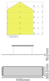
**Caractéristiques Ledvance Dalle LED Suspension luminaire 36W 3800lm - 830 | 120x30cm - Dali Dimmable - Direct/Indirect - UGR <19**
