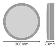
**Caractéristiques Ledvance Surface Bulkhead 300 15W 840 1400lm Noir IP65 | Éclairage de secours 3H avec détecteur**
